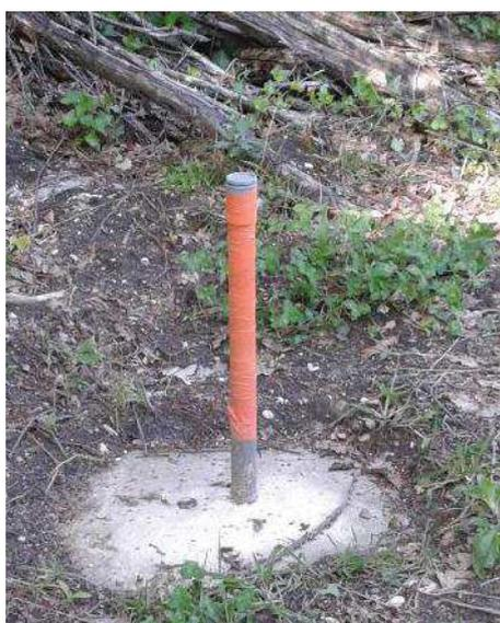
Figure 13 : Vue du piézomètre Pz1 présent dans l'emprise de projet (ENDEO Environnement)
