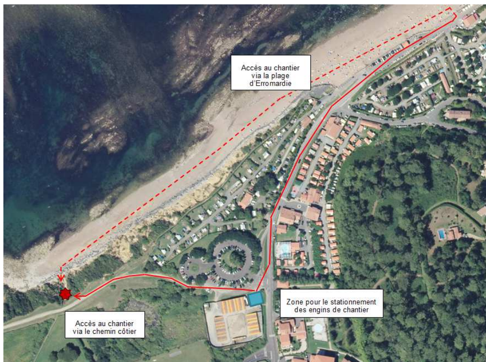
Figure 62 : Voies d'accès chantier
