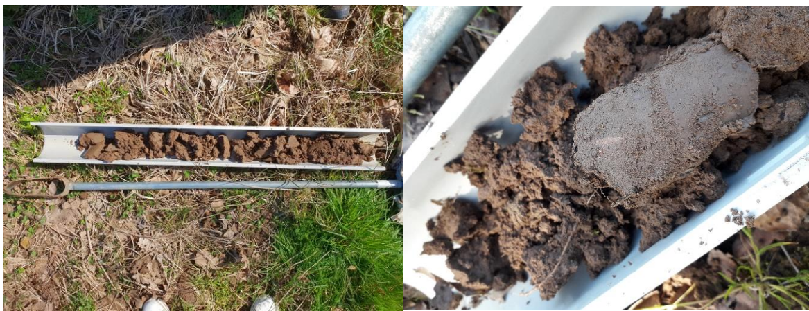
Figure 6 Illustrations des essais à la tarière réalisés : absence de traits rédoxiques (Source : GEOCIAM)
