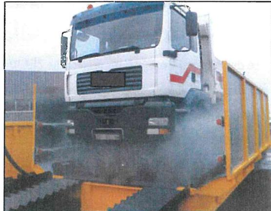
Figure 14 : Exemple d'un laveur décrotteur de camions et engins de TP
