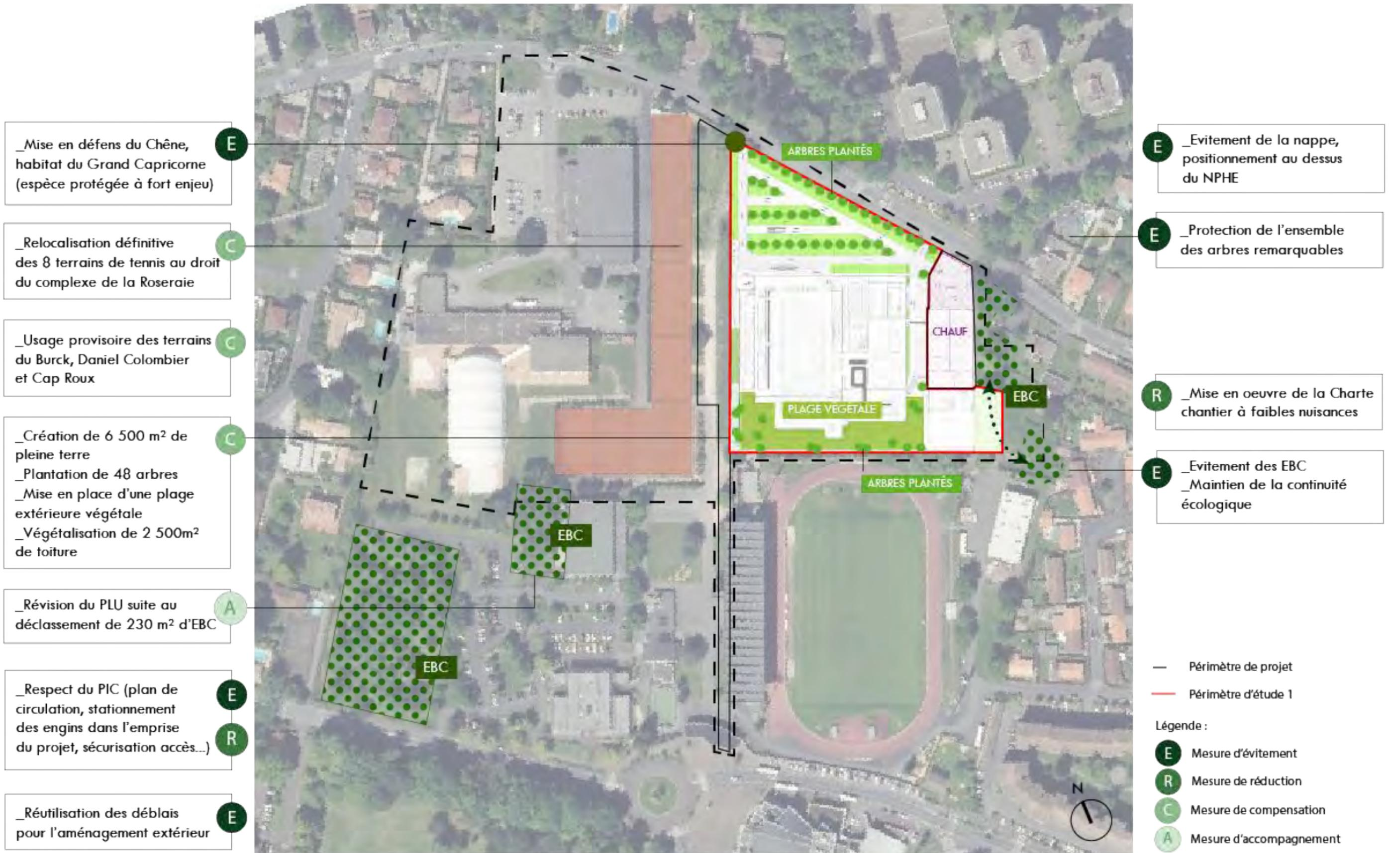
Mesures ERC à l'échelle des périmètres de projet et d'étude 1 en phase chantier - Source: ALTO STEP
