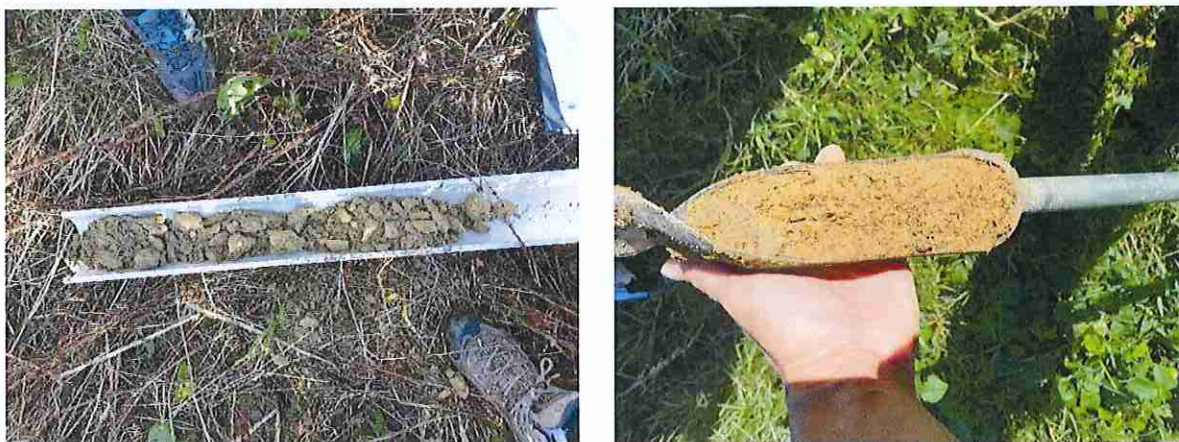
Figure 4 Illustrations des essais à la tarière réalisés : absence de traits rédoxiques (Source : GEOCIAM)
