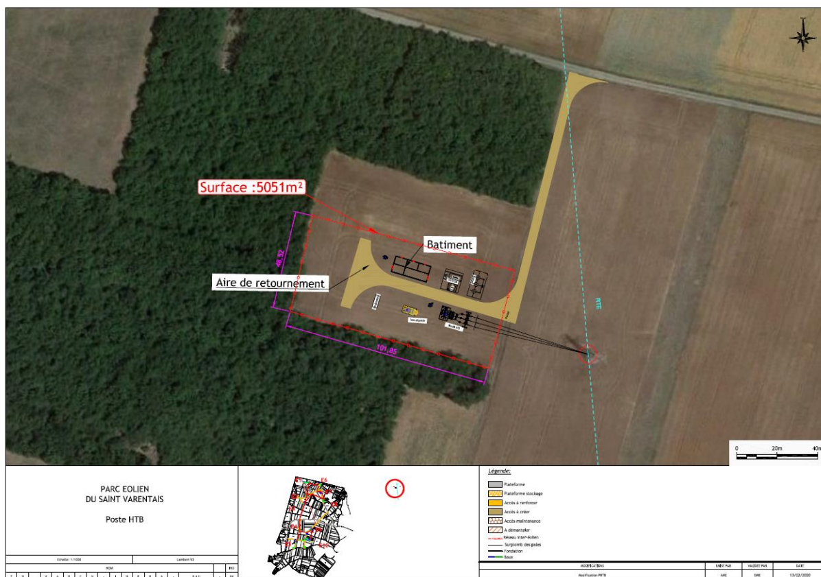
Figure 9 : Implantation pressentie du poste électrique
