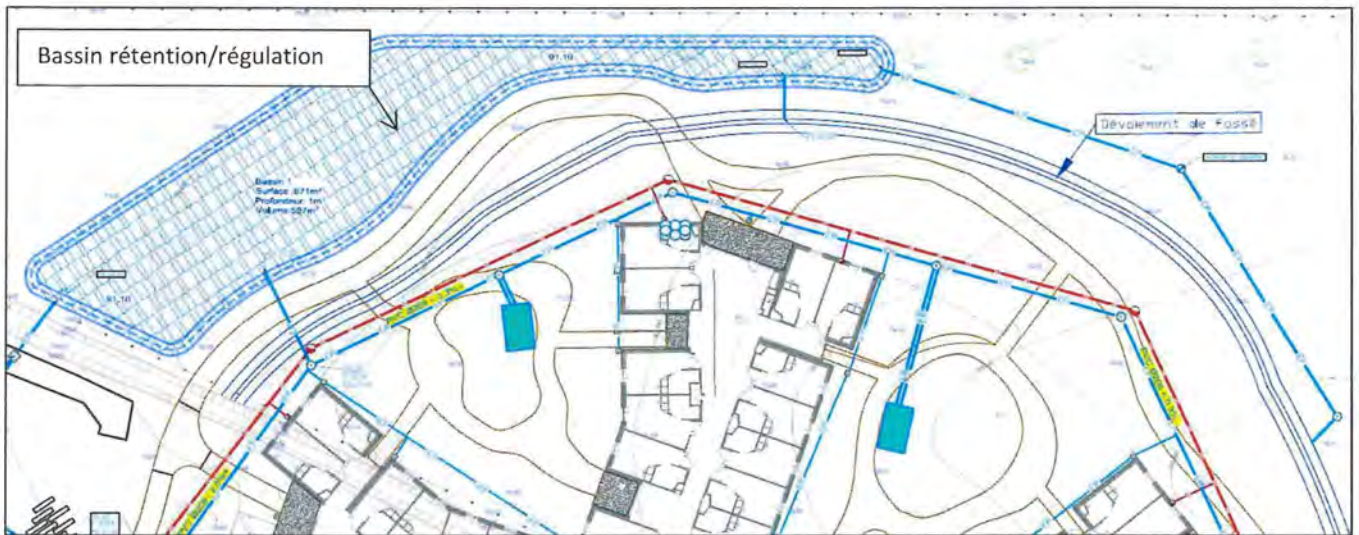
Figure 22 : Zoom sur le bassin de rétention/régulation
