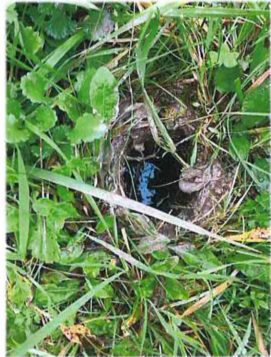
Sondage 5 (Eau atteinte)
