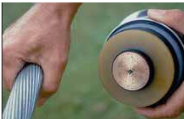
Illustration 6 : Câble nu aérien à gauche et câble souterrain isolé à droite
