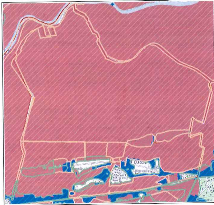
Cartographie du PPRi sur la commune d'Yzosse. En rouge et bleu, les secteurs affectés par un risque d'inondation.
