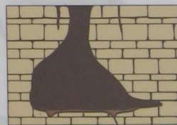
Formation d'une cavité souterraine en milieu calcaire
