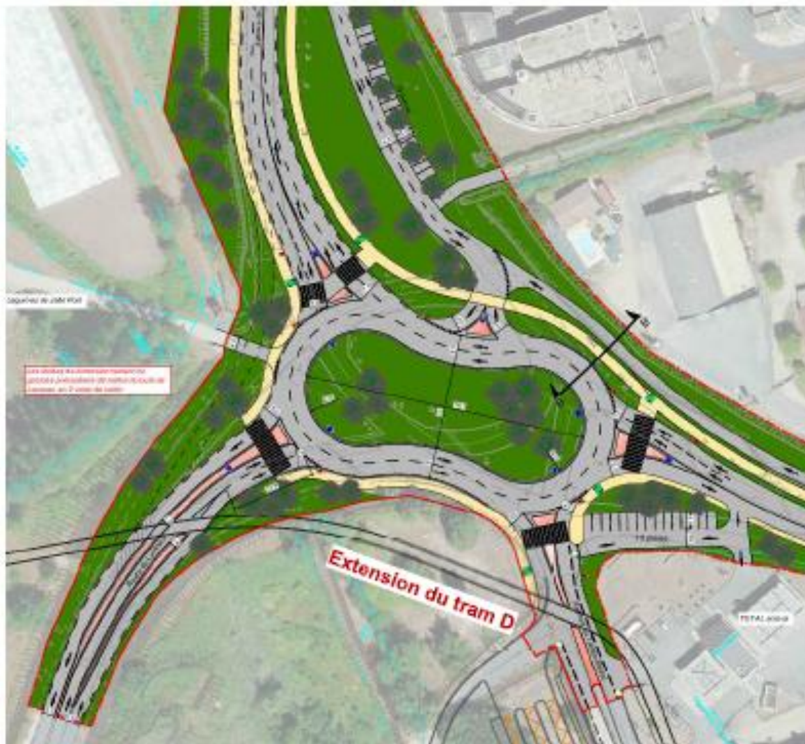
Figure 13 - Extrait du plan d'aménagement du scénario 3 - Giratoire "cacahuète"
