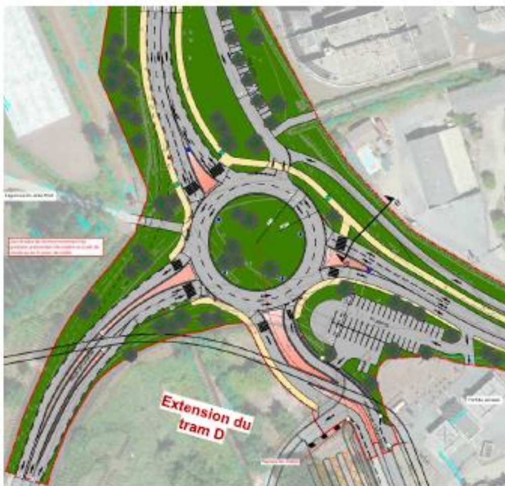
Figure 11 - Extrait du plan d'aménagement du scénario 1 - Giratoire circulaire
