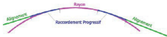
Figure 4 - Eléments géométriques du tracé en plan
