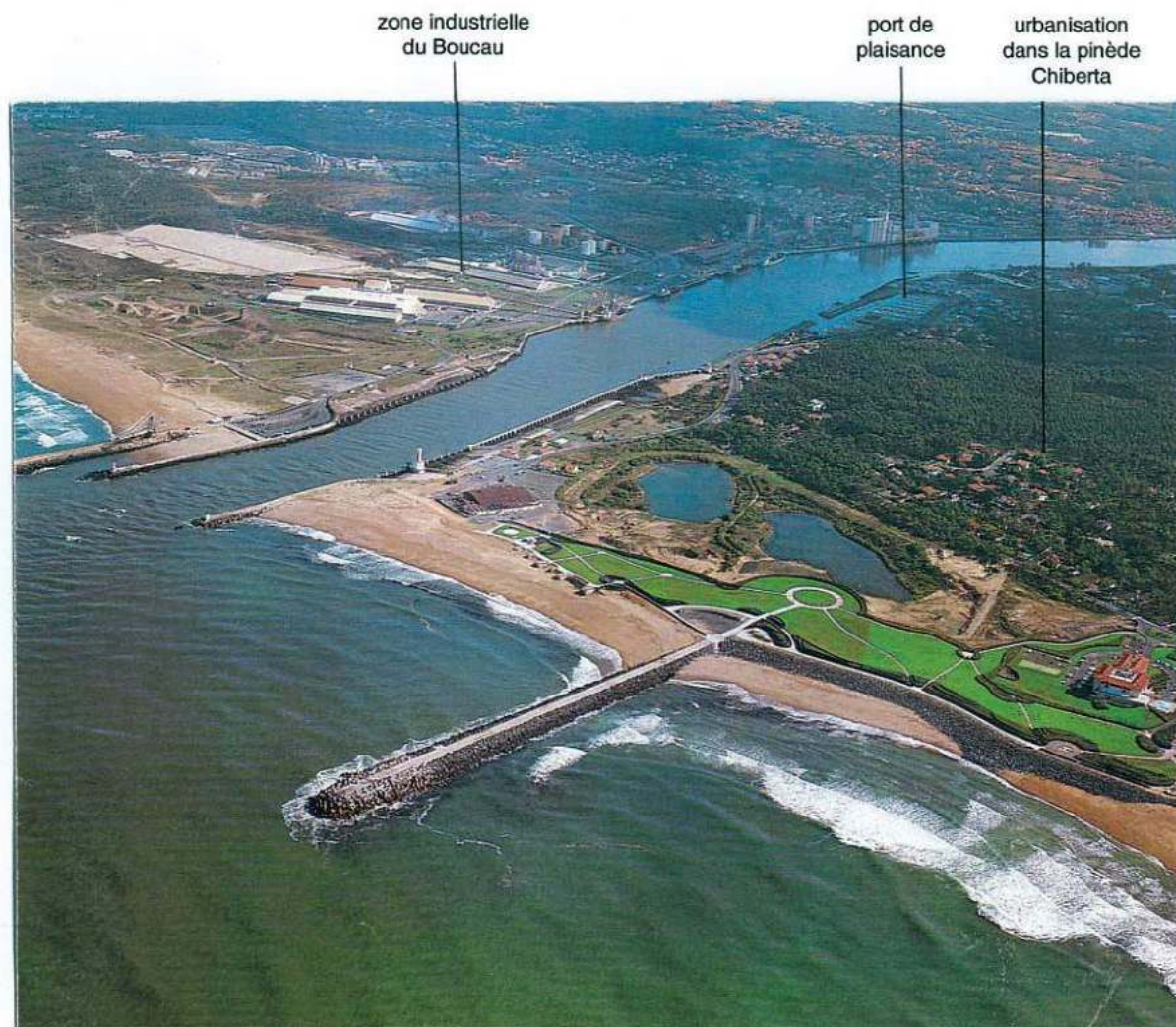
Embouchure canalisée de l'Adour. Face à la zone industrielle en rive droite, on distingue le petit port de plaisance du «Brise-lames». Un succession de jetées et de brise-lames protègent la côte. (photo aérienne P. Laplace)
