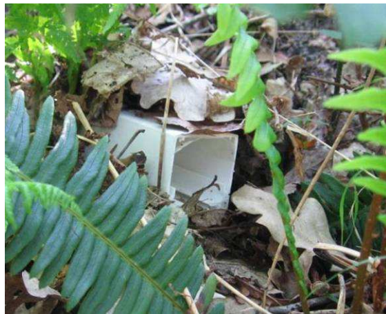
Tube capteur (goulotte électrique de 40x40 cm) mis en place dans le milieu naturel. (Photo : GREGE/C. BOUT).
