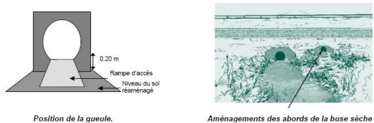
Figure 31 : Principes d'implantation des buses sèches
