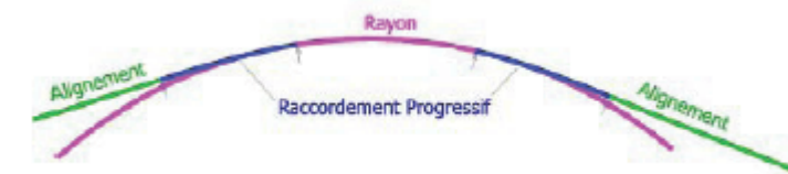
Figure 4 - Eléments géométriques du tracé en plan
