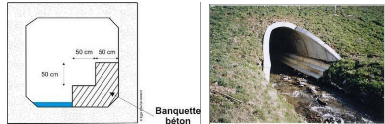
Figure 30 : Principe de dimensionnement de banquette, et aménagement réalisé sur A89
