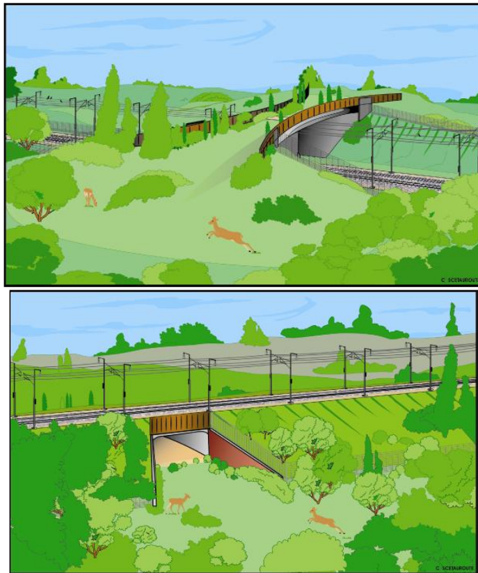
Figure 36 : Schémas de principe d'ouvrages spécifiques supérieur et inférieur pour la grande faune
