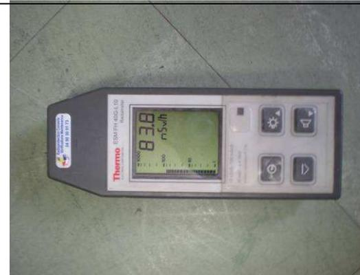
Scintillomètre portatif SPP $\gamma$
