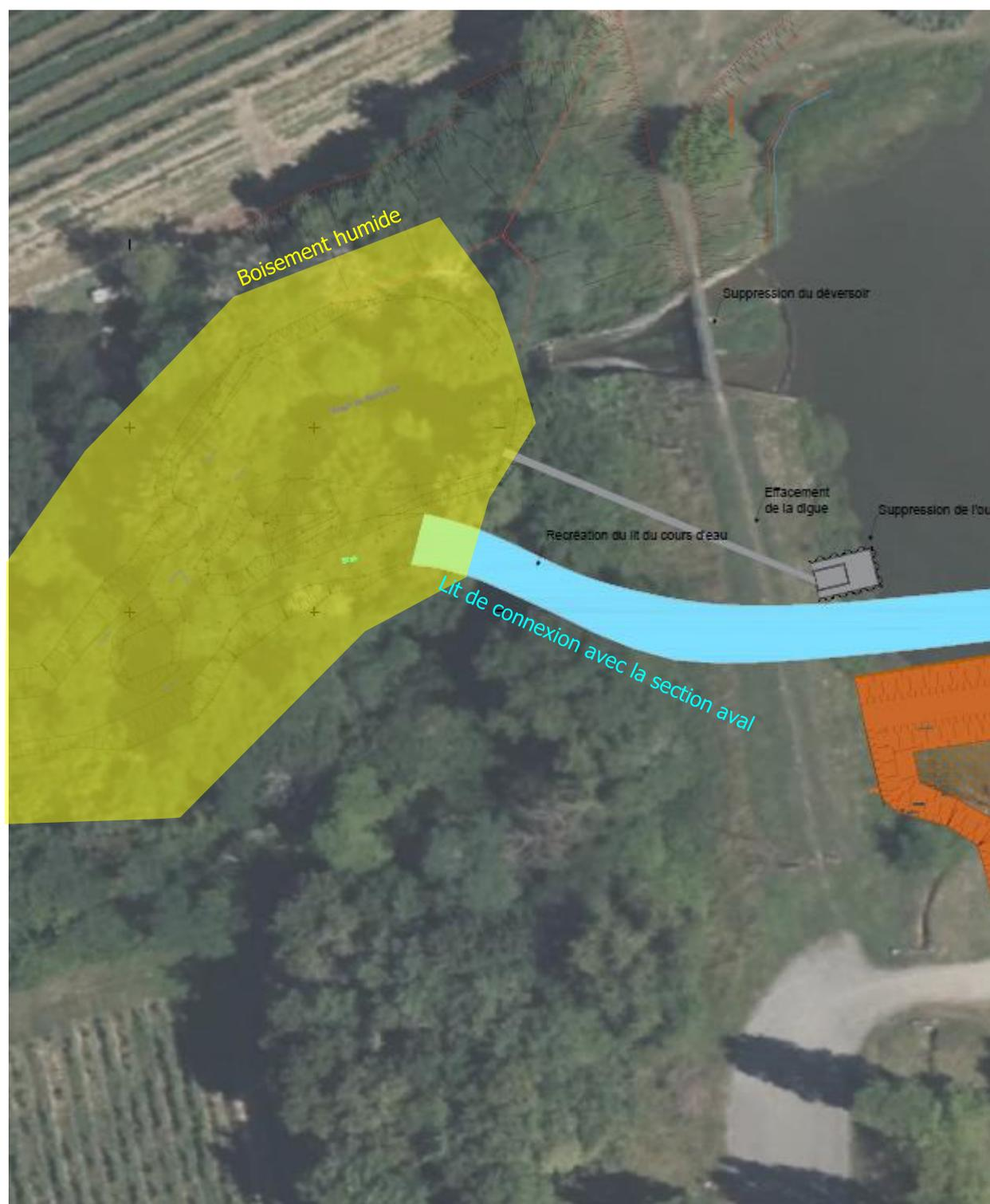
Figure 44 Plan de la création du lit de connexion avec la section aval.
