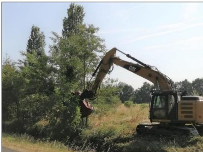
*Figure 7 Exemple de pelle équipée de broyeur*
