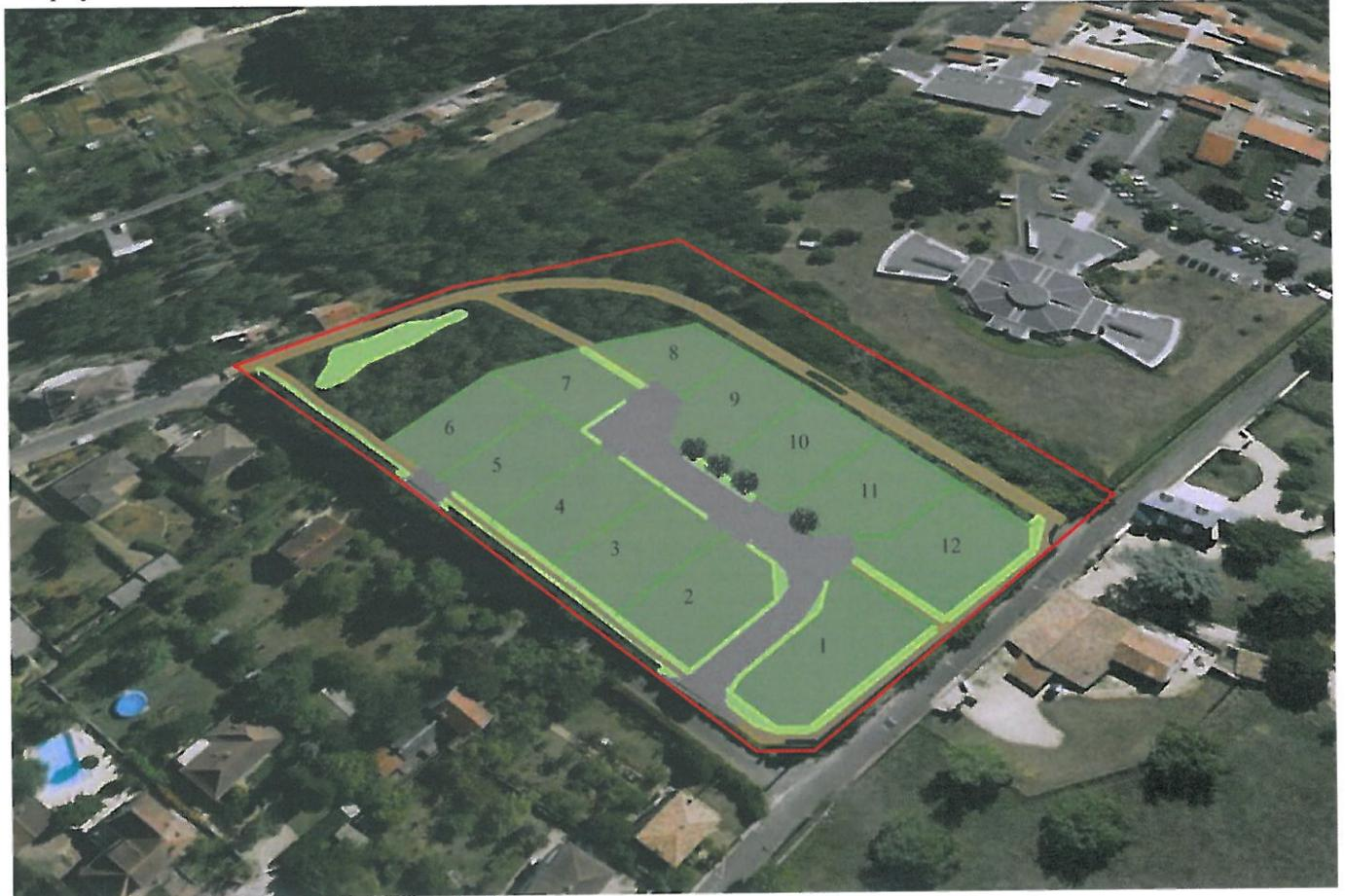
Une noue de stockage sera créée dans la zone boisée pour permettre la récupération et l'infiltration des eaux de ruissellement de la voirie.
