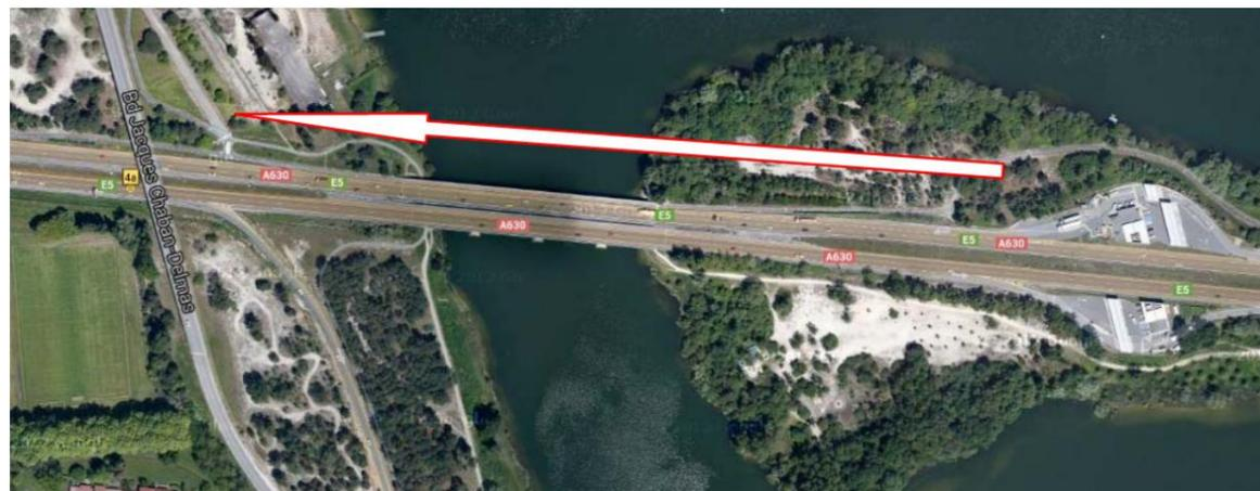
A l'ouest, la piste existante assurant le passage sous les VIPP (liaison Lormont-Bordeaux) sera conservée et un remblai d'accès vers la passerelle aménagé. La hauteur du remblai dépend de la solution structurelle retenue.
