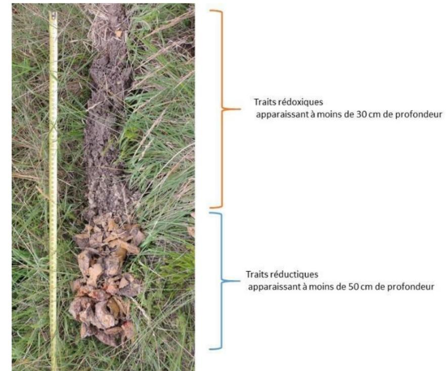
Figure 24 : Profil pédologique caractéristique d'une zone humide (sondage n°A3)
