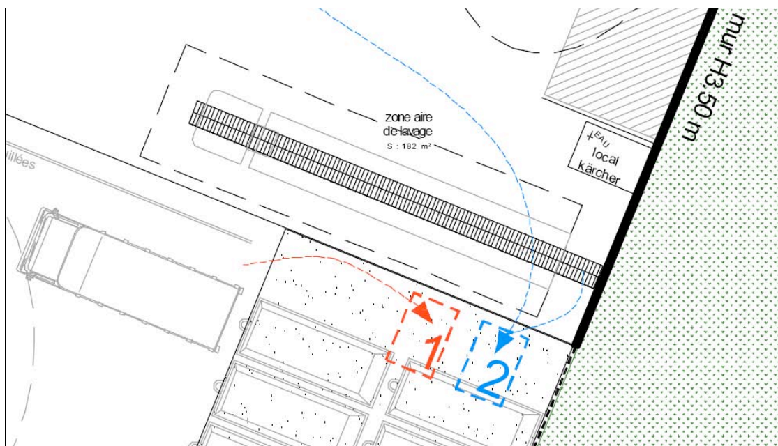
Extraits du plan de masse localisant les séparateurs à hydrocarbures (source : HOB0 Architecture)
