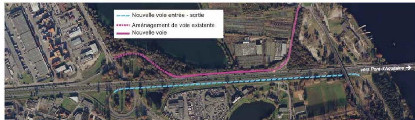
FIGURE 23 : LIAISON ÉCHANGEURS 4A ET 5 – OPTION 3
