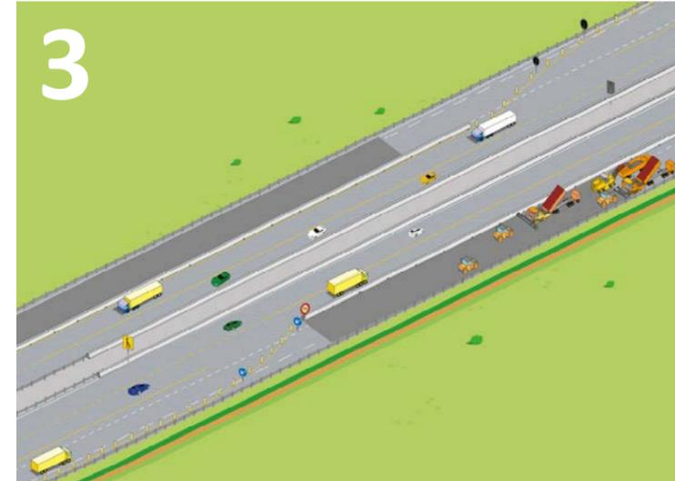
Lors de cette troisième phase, on réalisera également les protections acoustiques, les travaux d'assainissement et de réseaux en bordure de la rocade.
