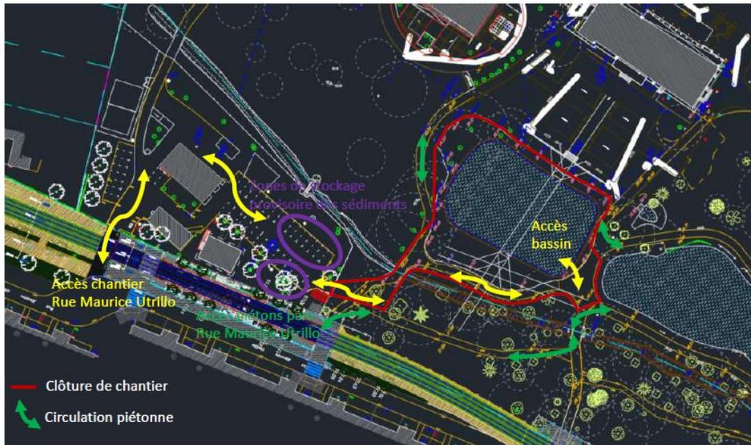
Figure 5 : Plan prévisionnel du chantier (source : MOTER)
