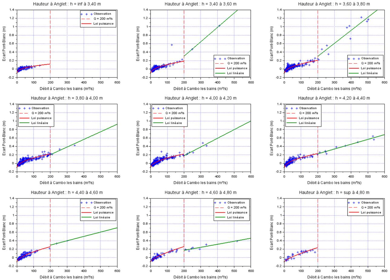
Fig. 6 : Influence du débit sur la sur-hauteur observée pour différentes classes de hauteur de pleine mer à l'embouchure.
