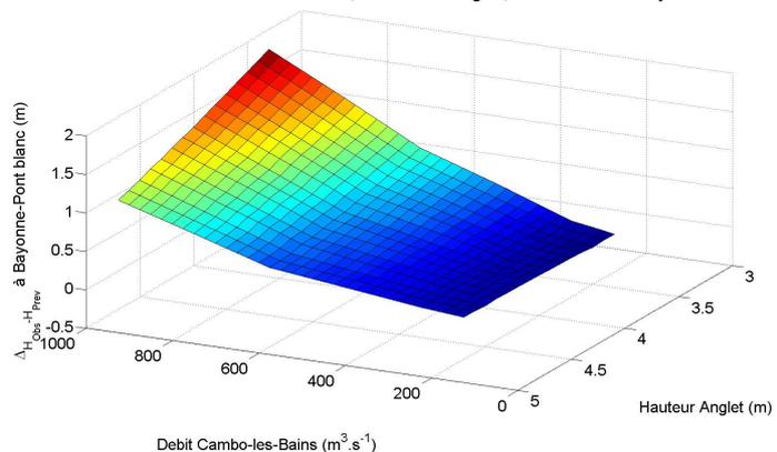
Fig. 10 : Représentation de la sur-hauteur obtenue par modélisation en fonction des pleines mers à Anglet et des débits de la Nive à Cambo-les-Bains.
