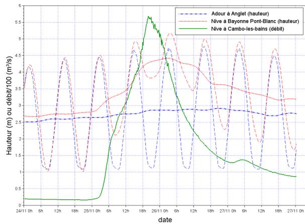
Fig. 2 : déformation du signal maritime à Bayonne Pont-Blanc (tirets rouges) au passage d'une crue de la Nive. Mise en évidence sur le signal de hauteur moyenné sur 25h à Bayonne-Pont-Blanc.
