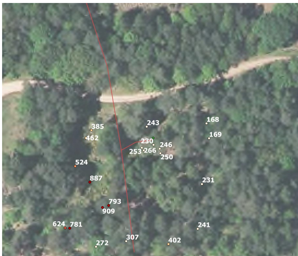
Valeurs SPPG mesurées autour de la clôture et à l'intérieur du site
