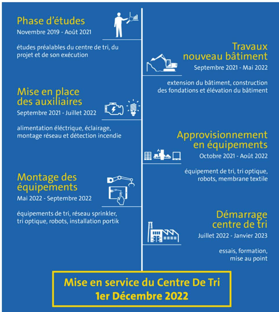
**Figure 6 : Timeline travaux de modernisation du centre de tri VALBOM de Bègles (Source : VALBOM)**
