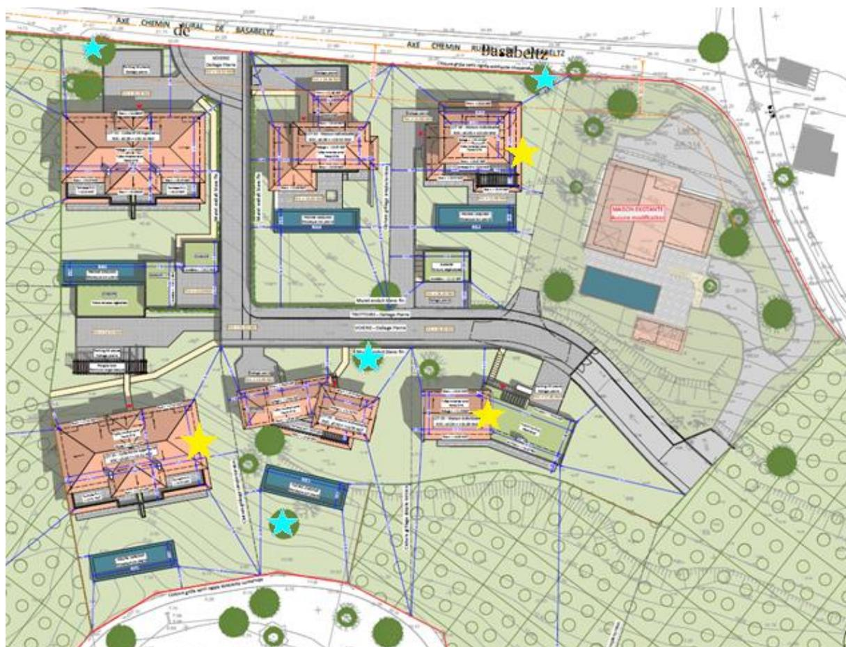
Localisation des gîtes artificiels pour les chiroptères, qui seront installés au sein de l'opération de construction (zone hameau) – étoile bleue : gîte artificiel installé sur les arbres ; étoile jaune : gîte artificiel installé sur les façades
