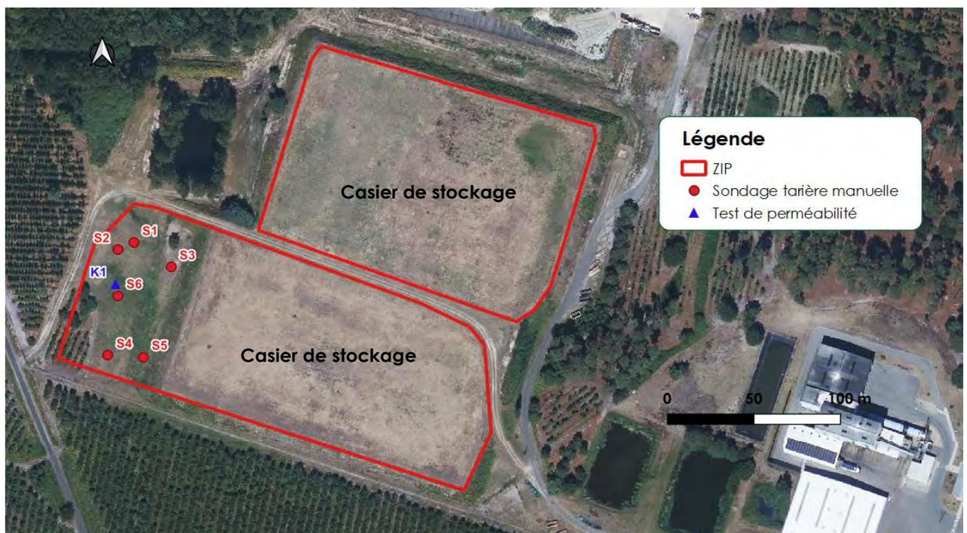
Figure 11 : Implantation des sondages et des tests de perméabilité
