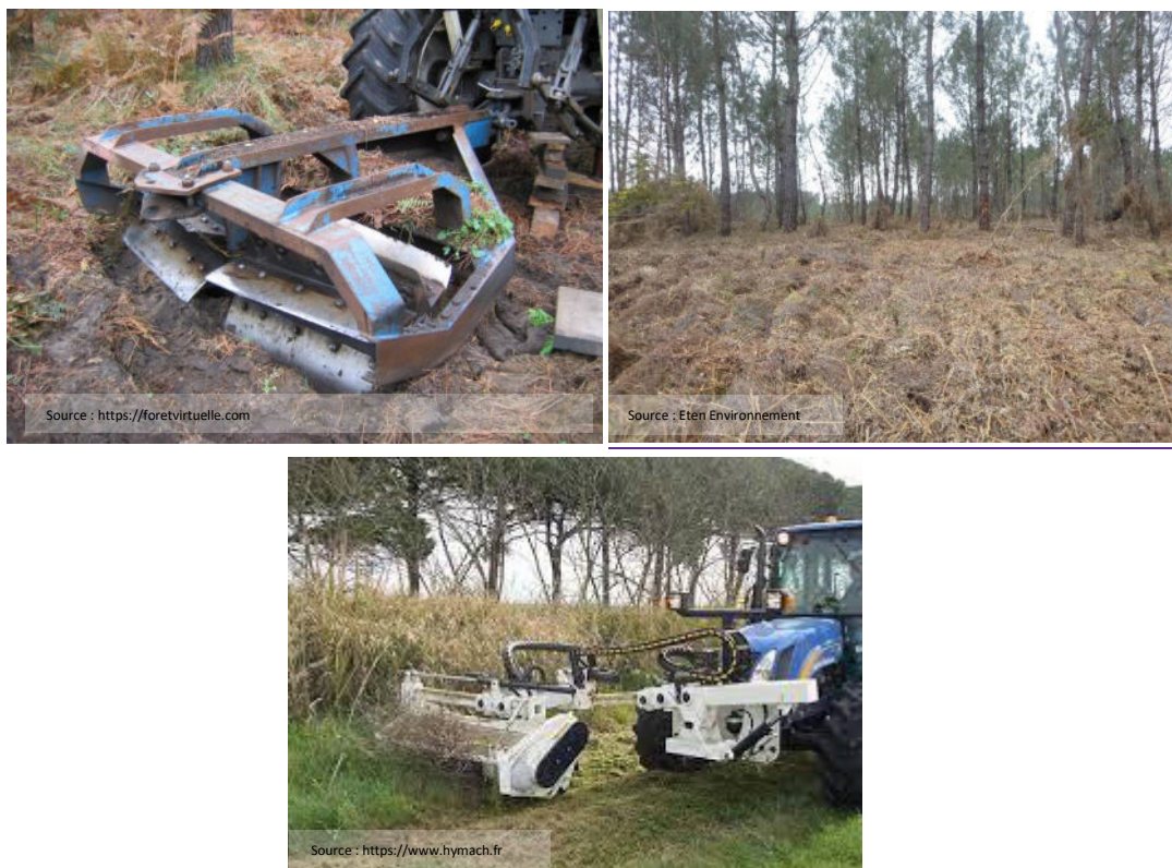
Figure 5 : Exemple de rouleau landais en haut à gauche, site de Beylongue après le passage du rouleau landais (en haut à droite) et gyrobroyeur en bas
