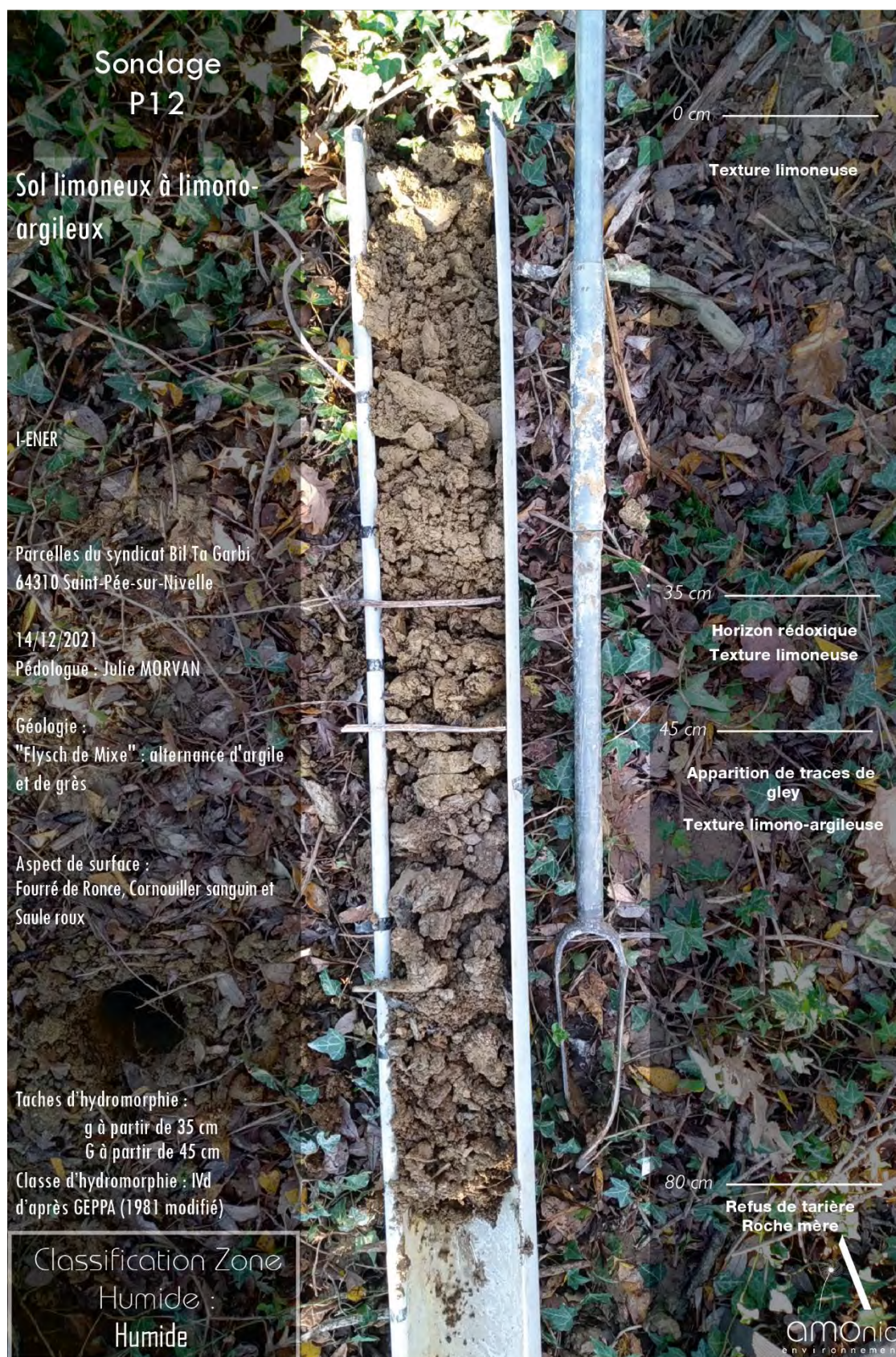
Figure 13 : Description du sondage P12
