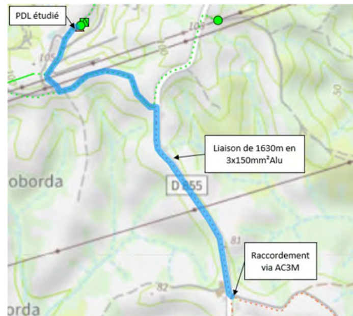
Figure 1 : Tracé de raccordement au réseau public d'électricité
