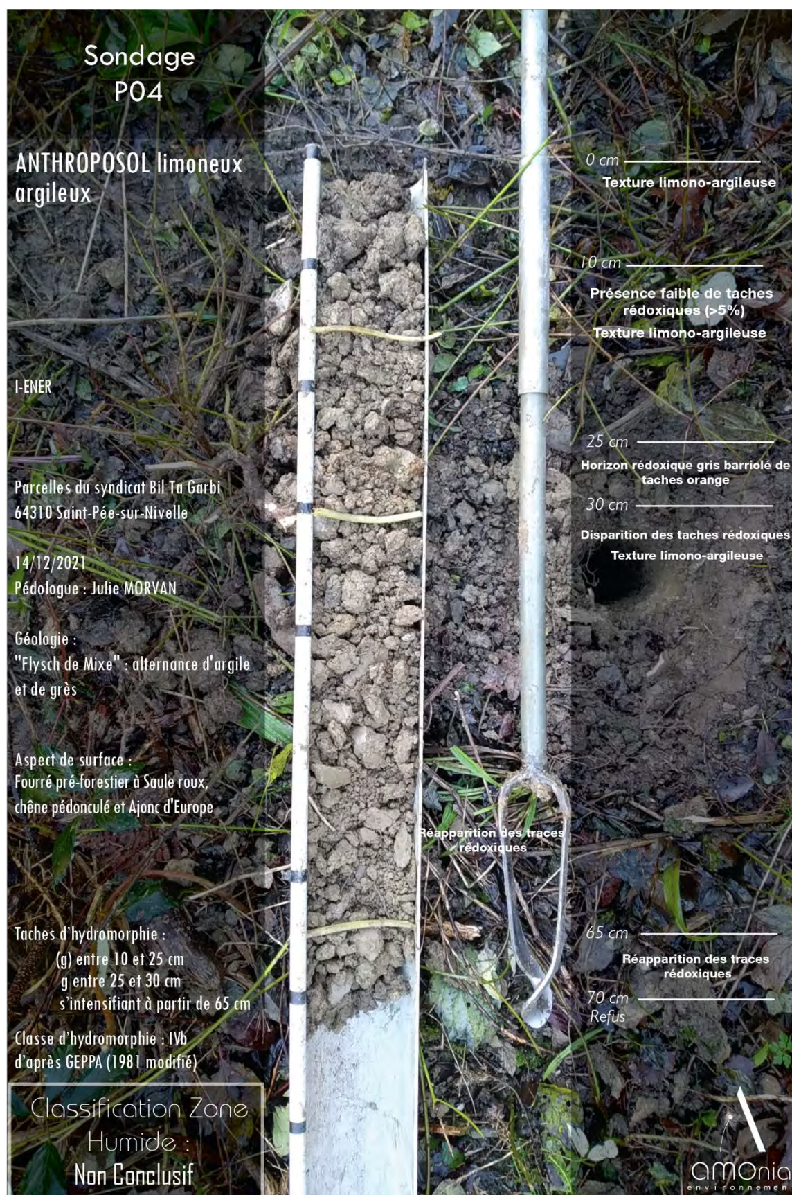
Figure 11 : Description du sondage P04
