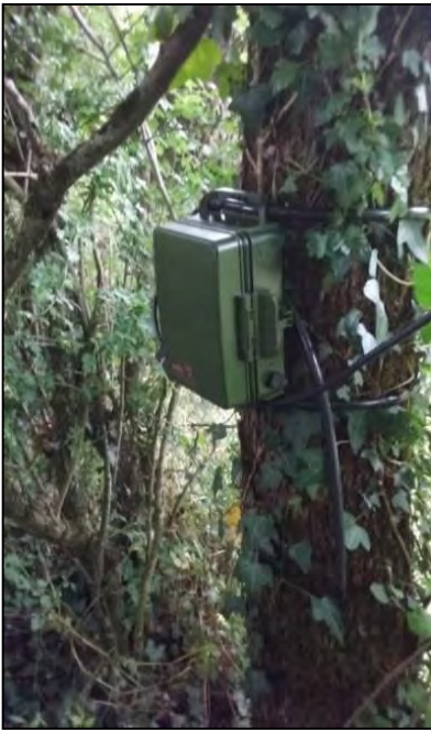
Figure 14 : Exemple d’installation d’enregistreur continu SM4BAT © NCA Environnement, 2020
