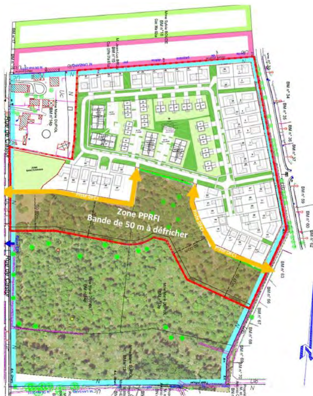
Figure 16 : Pistes PPRFI et bande (50 mètres) d'obligation légale de débroussaillage
