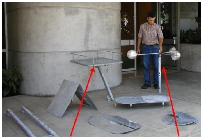
Figure 40 : Plateforme portugaise et anémomètre (RTE)
