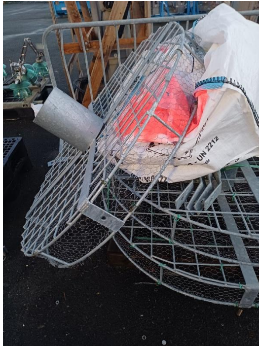
Figure 89 : Plateforme ronde utilisée par Enedis Poitou-Charentes. Les plateformes carrées sont à privilégier avec un maillage métal sur le côté (dvéveloppement envisagé par la LPO) (Cédric FAVRIOU / Enedis Poitou-Charentes).
