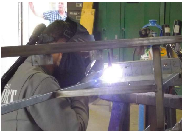
Figure 13 : Création d'un escalier par les serruriers de la ville pour le franchissement d'un ouvrage hydraulique
