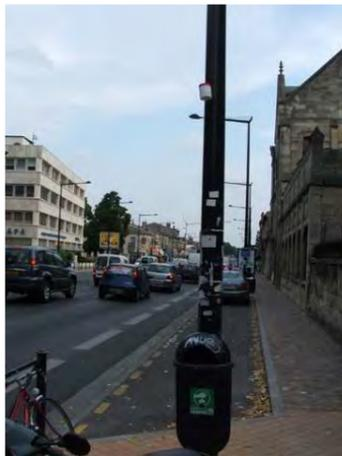
Point de mesure de proximité automobile équipé de tube à diffusion passive
