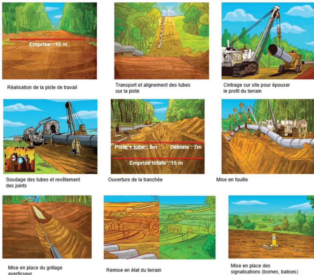
Figure 8 : Présentation des travaux de pose d'un gazoduc en tracé courant (source : TEREGA)
