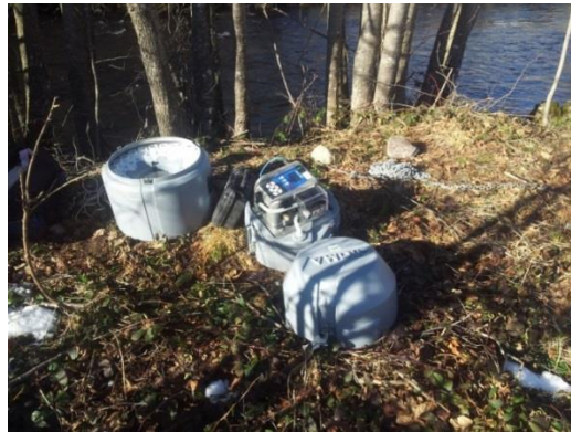
Figure 8 : Préleveur automatique déployé sur alerte débit durant l'hiver 2014-2015.
