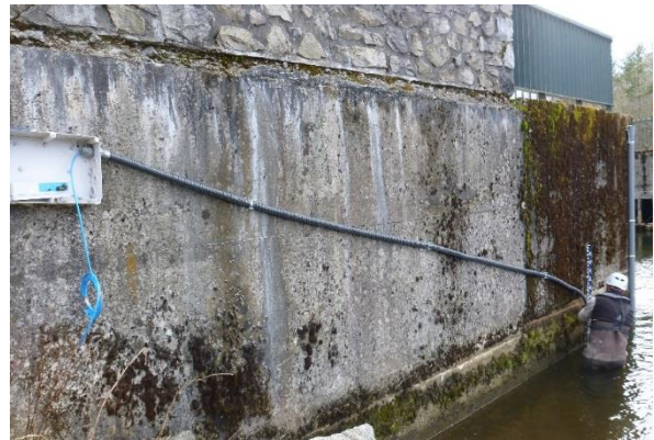
Figure 2 : Capteur de niveau d'eau de la station sortie Lac (à droite) / déchargement de l'enregistreur (à gauche)
