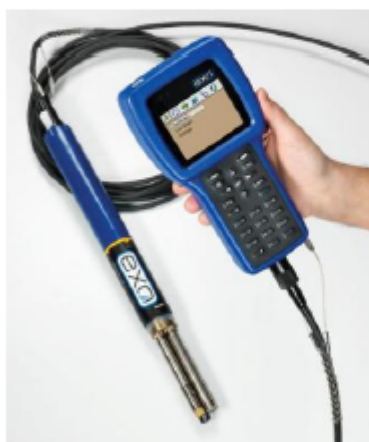
Interfacez la sonde ExO avec le terminal ExO
