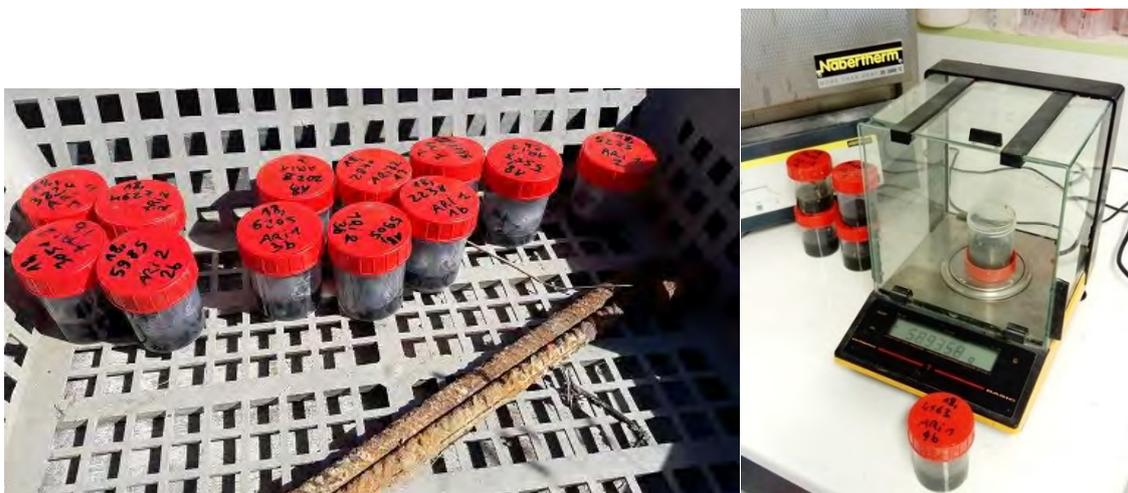
Figure 20 : Echantillons pesés à la balance de précision
