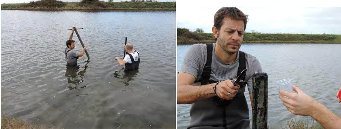
Figure 19 : Prélèvements des 1<sup>er</sup> et 2<sup>ème</sup> cm de vase dans la carotte
