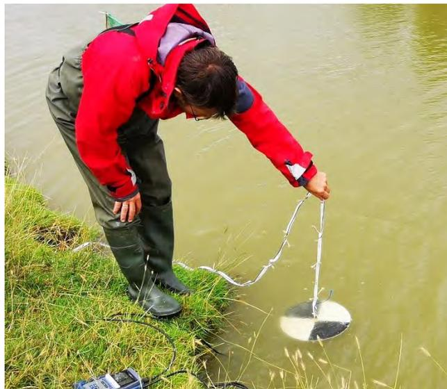
Figure 18 : disque de Secchi
