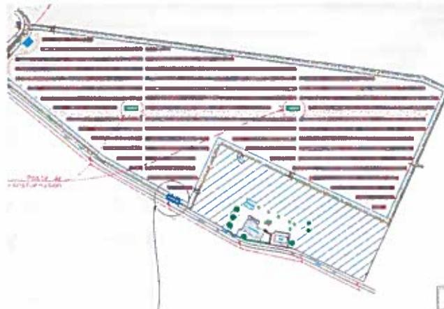
Plan d'implantation des panneaux (source : PC5 – plan de masse)
