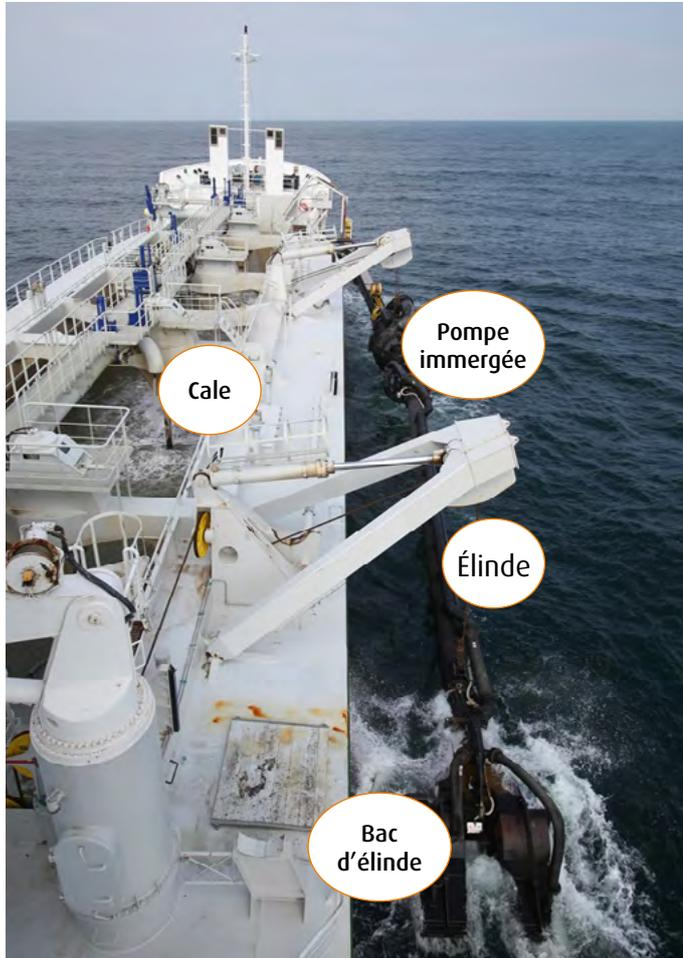
Figure 7 : Principe de l'extraction de granulats marins par un navire équipé d'une élinde trainante
