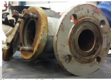
Clapet anti-retour avec bride cassée
