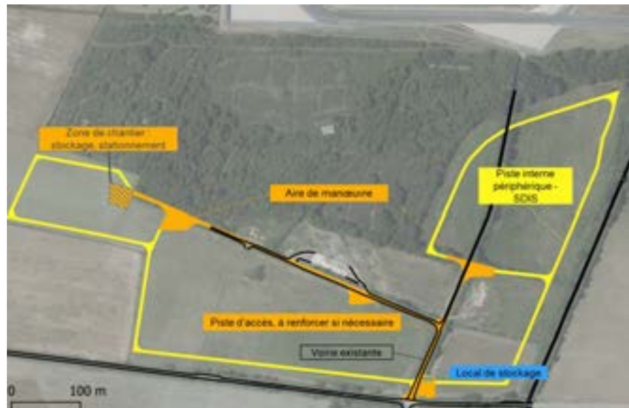
Figure 68 : Schéma des pistes et zone de chantier © VALOREM
