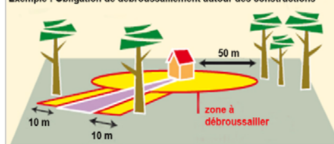
Schéma de réalisation du débroussaillage, source : plaquette sur le débroussaillage, DFCI Aquitaine, préfecture des Landes.
