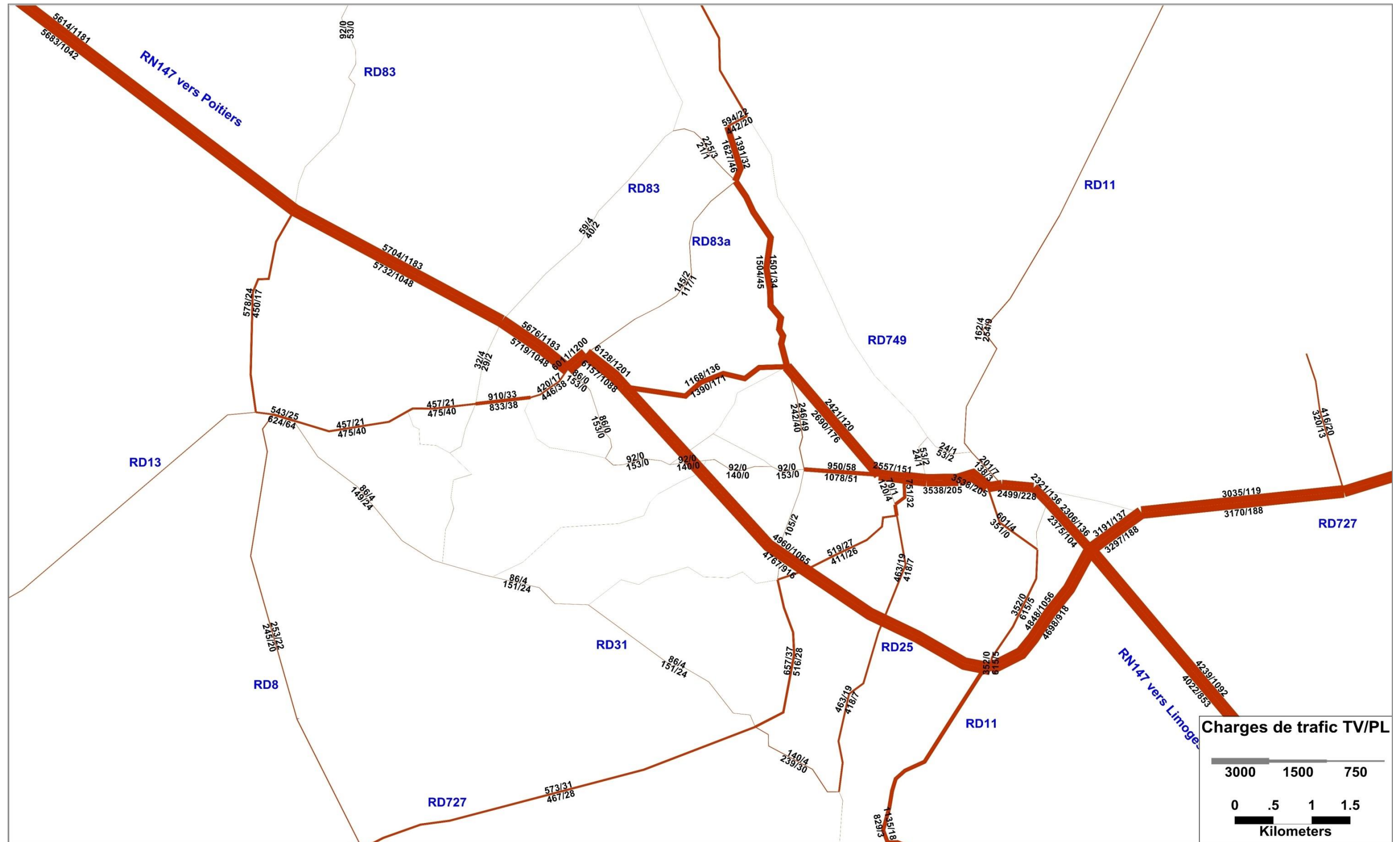
Charges de trafic TMJA TV/PL du Scénario 3 : VJLGV à 2x1 voies à l'horizon 2022
