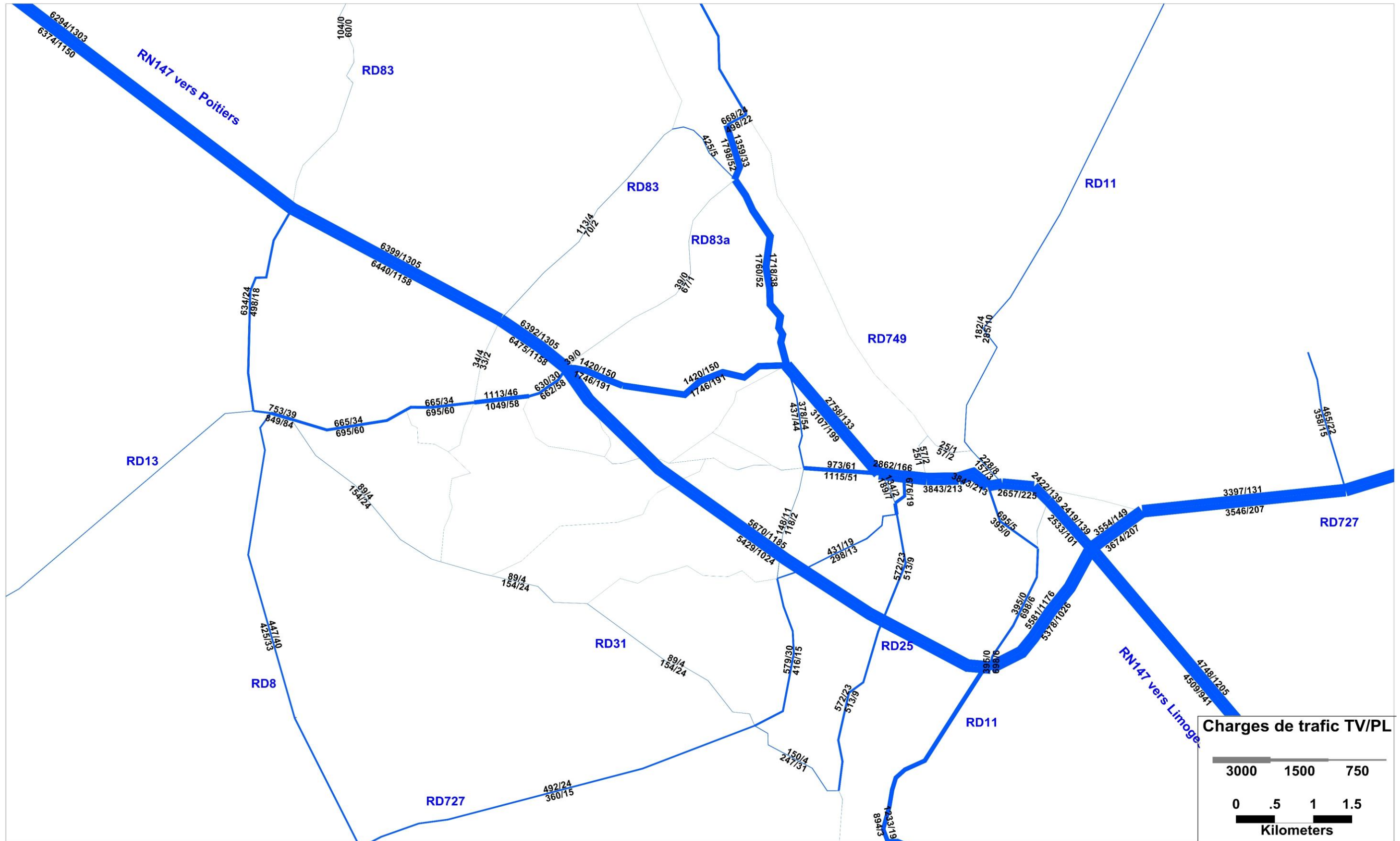
Charges de trafic TMJA TV/PL du Scénario 1 : V2006 à 2x1 voies à l'horizon 2042
