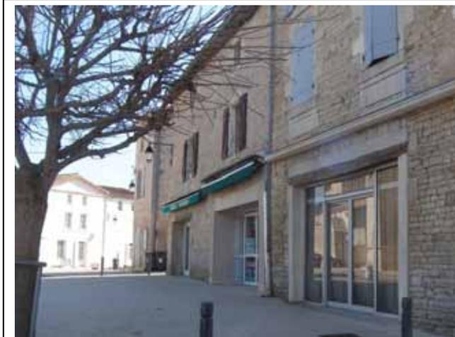
L'agrandissement des percements du rez-de-chaussée sur toute la largeur de la façade est interdit. On perd la cohérence de la composition entre le rez-de-chaussée et l'étage.
