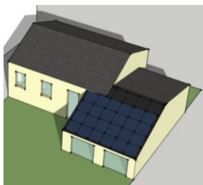
Intégration sur tout un pan de toiture
