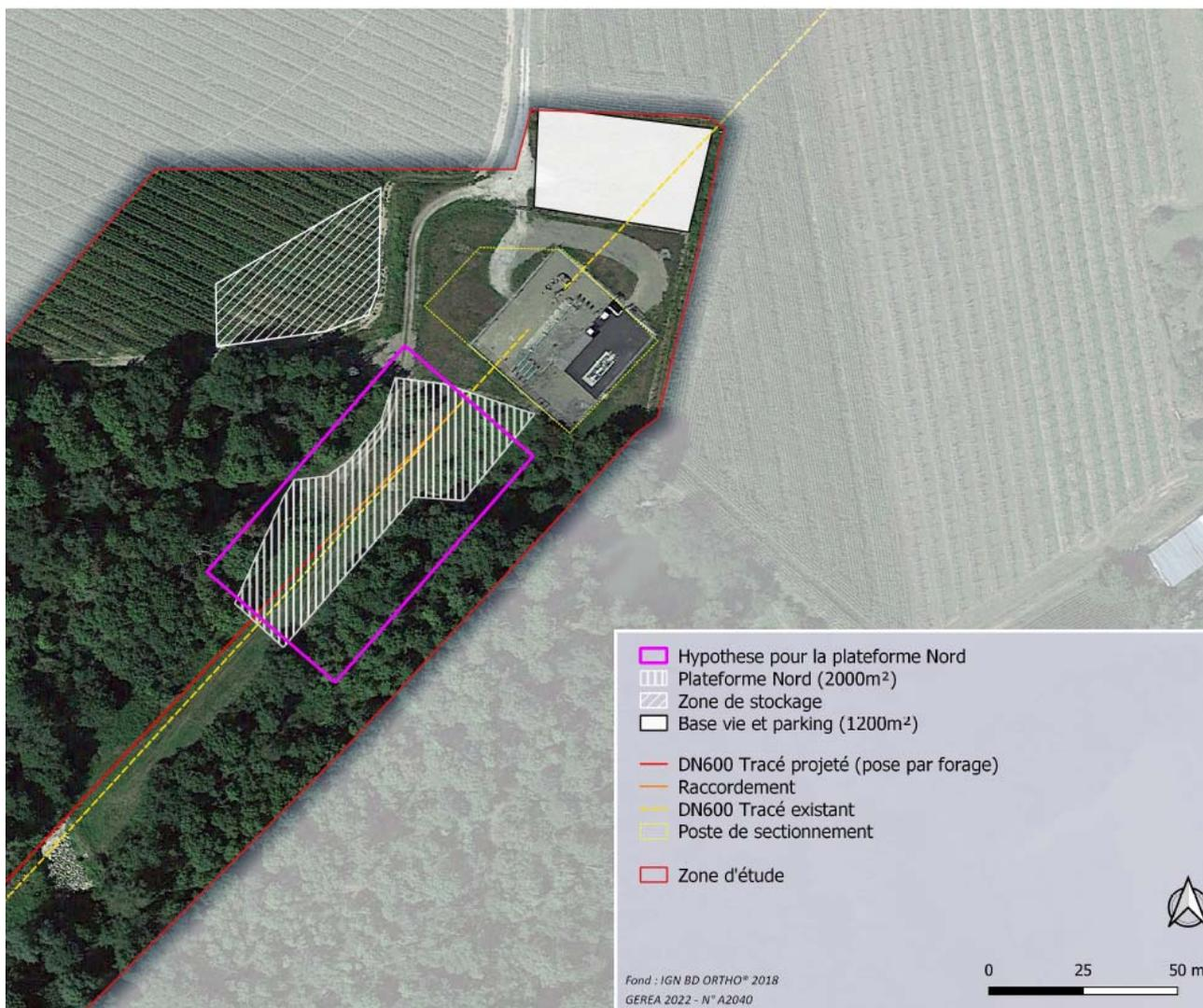
Figure 31 : Implantation de la plateforme de forage nord
