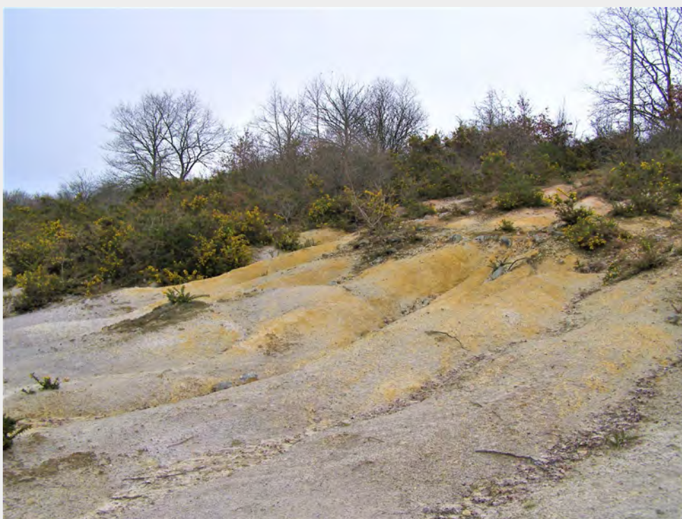
Front de taille de la carrière des Blanchères (excavation sud-est) montrant l'érosion des altérites argilo-sableuses liée au ruissellement des eaux de pluie. (photo : Didier Poncet)
