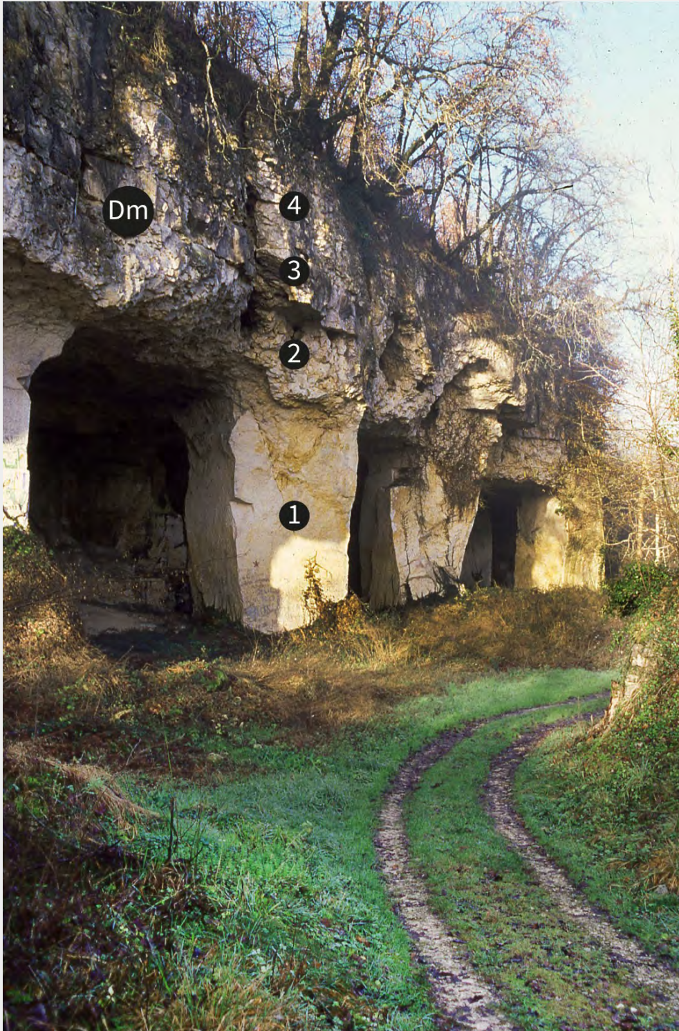
Front de taille de la carrière du Breuil avec position des quatre assises (① ② ③ ④) et du hard-ground (Dm). (photo : Didier Poncet / DAO : Fabienne Rayanrd)
