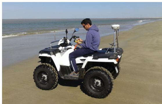
Figure 3 : Quad équipé d'un GPS utilisé pour les levés topographiques de la plage et de l'estran.
